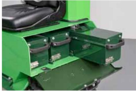
Geregelte Trockenakkus der neuesten Generation, hohe Energiedichte im leichten Wechselfack
